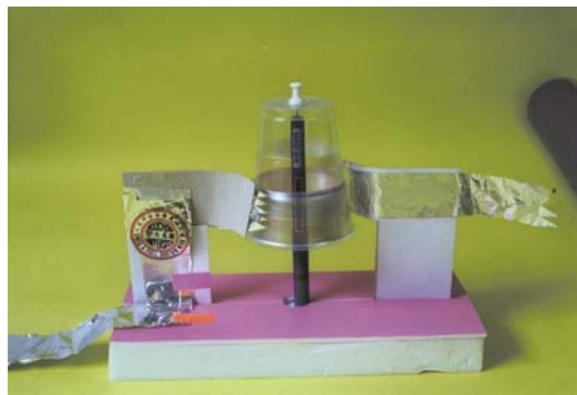
圖五 水晶杯製成的富蘭克林馬達運轉的情形。
